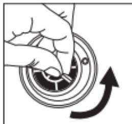
Für den Austausch des Filters den Deckel von der Flasche abschrauben, den Filter gegen den Uhrzeigersinn drehen und durch Ziehen nach oben entfernen.
