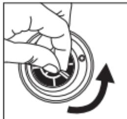
Para la sustitución del filtro quitar el tapón de la botella, girar el filtro en sentido antihorario y sacarlo halándolo hacia arriba. Sustituirlo con uno nuevo repitiendo las operaciones como en los párrafos "PREPARACIÓN DEL FILTRO FAST DISK™".
