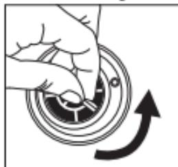
Para a substituição do filtro, retire a tampa da garrafa, rode o filtro em sentido anti-horário e remova-o puxando-o para cima. Substitua-o por um novo repetindo as operações conforme na secção "PREPARAÇÃO DO FILTRO FAST DISK™".
